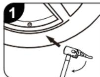
Collegare saldamente il tubo di gonfiaggio alla valvola dello pneumatico.
