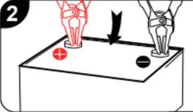
Collegare le pinze della batteria in modo sicuro e corretto ai terminali della batteria del veicolo.
