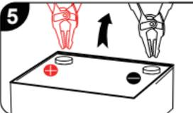
Scollegare prontamente le pinze della batteria dalla batteria del veicolo dopo l'avviamento.
