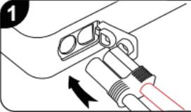
Inserire le pinze della batteria nella porta EC5 sull'avviatore.
